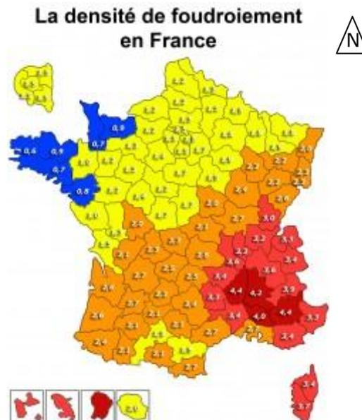
**Figure 1 : Densité de foudroiement sur le territoire métropolitain (source : <http://www.paratonnerres-radioactifs.fr/?p=7615>)**
